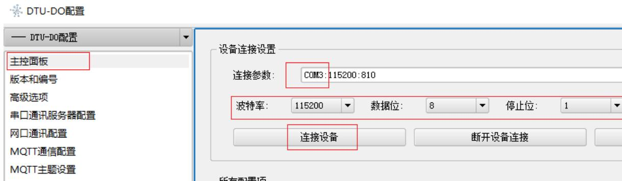
正确设置串口参数，点击：连接设备。
