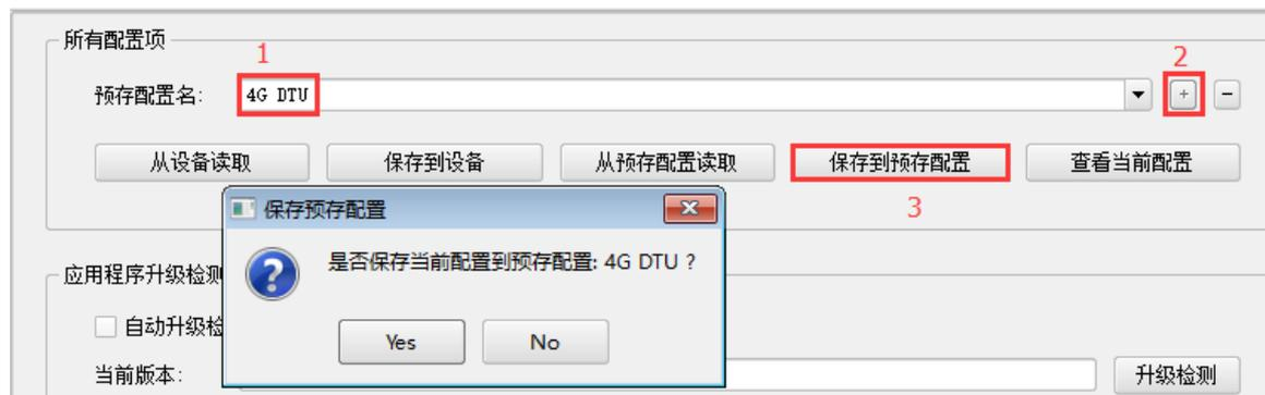
点击**保存到预存配置**按钮即可将用户修改的配置参数，以文件的方式保存，便于以后直接读取配置文件并快速完成 DTU 的配置。
